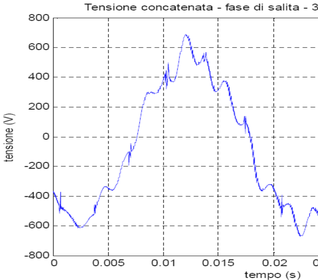
Fig. 6-2. Forma d'onda misurata di una tensione concatenata.
