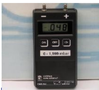
Fig. A2.10 Modulo elettronico PP471 e sonde della serie 704 e 705 per la misura di pressione.
