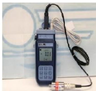
Fig A2.11b: Satema HD212 strumento portatile con sonde esterne.
