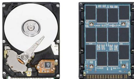
Figura 13:Le due tipologie principali di sistemi di storage HDD e SSD [59]
