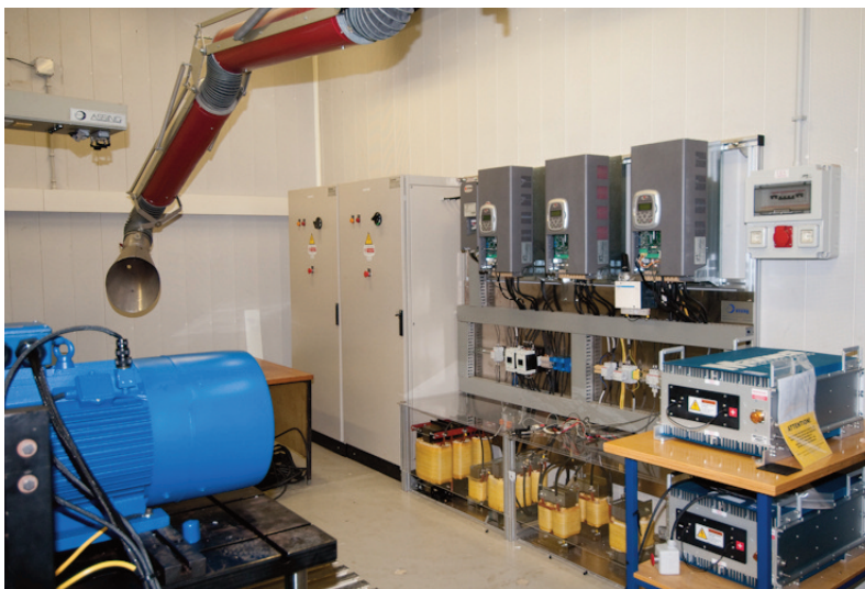
Vista del prototipo di impianto di sollevamento con recupero di energia tramite supercondensatori
