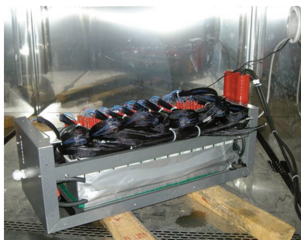
Il sistema di batterie usato come banco di prova per la messa a punto del prototipo finale
