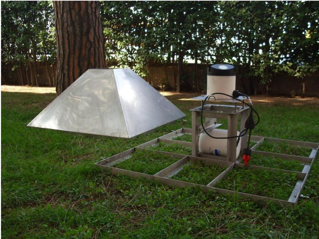
**Struttura con Argonaut XR montato e copertura**
