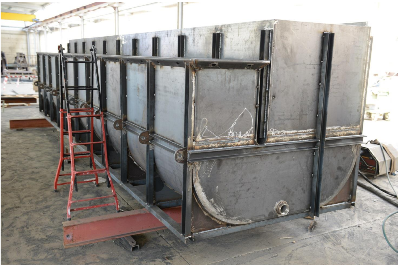
Figura 7. Struttura di sostegno del U-OWC (in alto), vista lato mare (destra) e lato terra (sinistra), e camera di assorbimento metallica (in basso).
