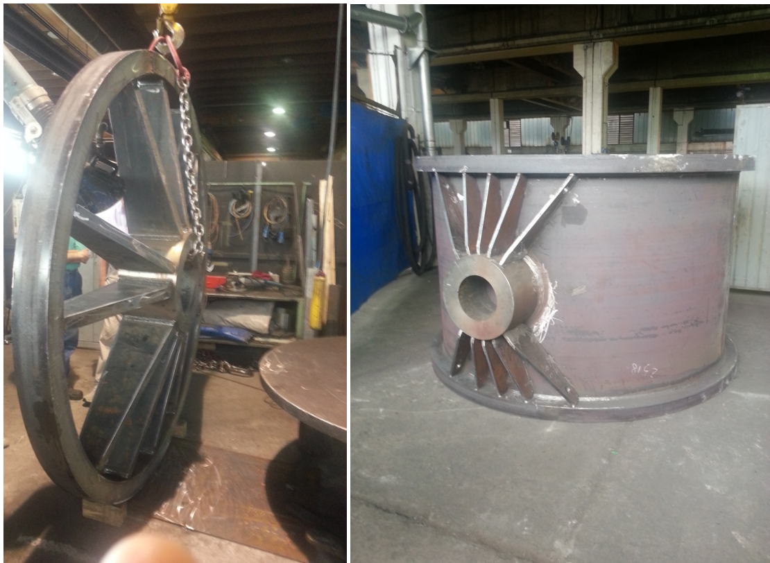
Figura 6. Il sistema ISWEC 100 kW: elementi realizzativi della piattaforma giroscopica.
