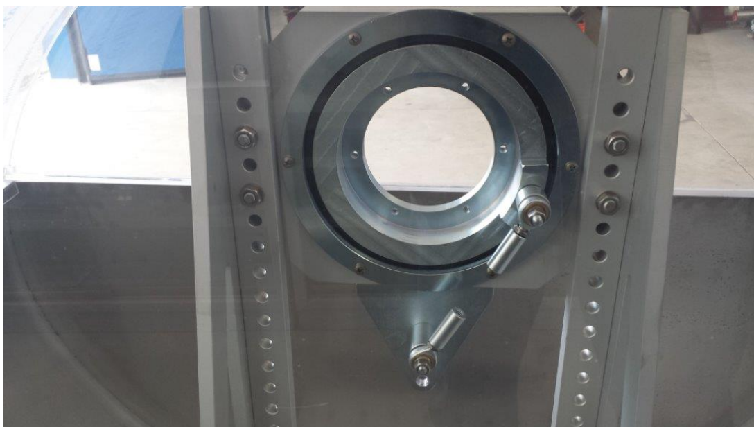
Figura 6 - Cuscinetto con attacchi della cella di carico
