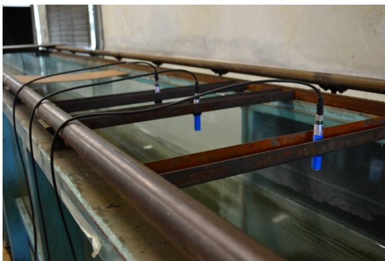
Figura 13 – Le sonde per la misura del profilo d'onda
