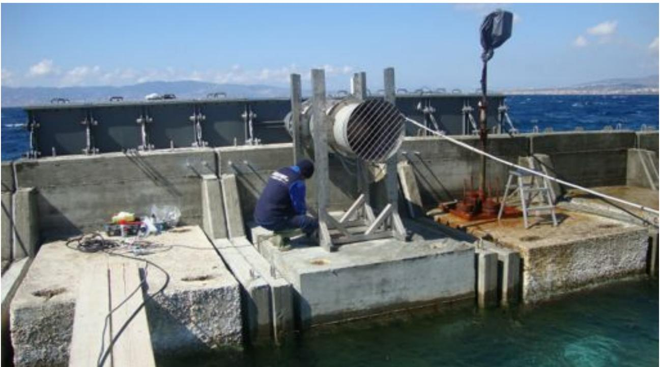
**Figura 7.** Turbina di tipo Wells, accoppiata al cassone metallico esistente presso il NOEL, progettata dal gruppo POSEIDONE dell'Università di Roma La Sapienza e realizzata dalla Faggiolati Pumps SpA.
