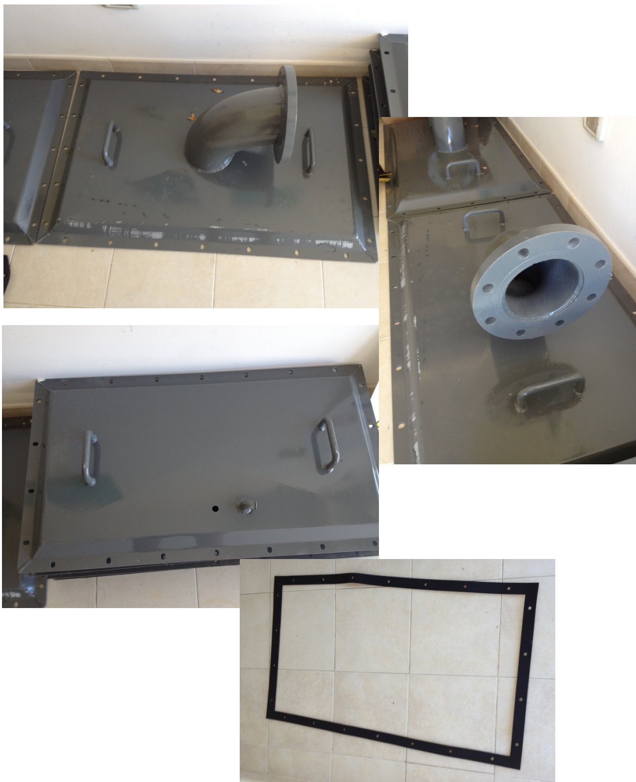
Figura 25. Particolari dei coperchi della camera di assorbimento e della guarnizione.
