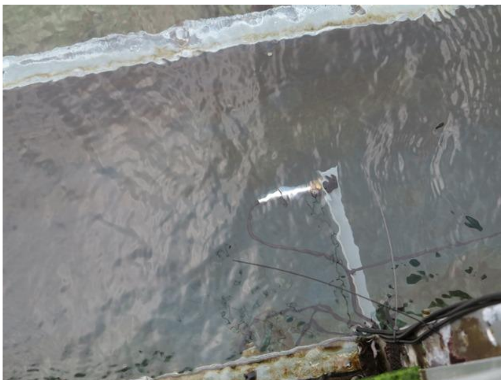
Figura 9. Trasduttore di pressione nell'imbocco del condotto verticale del REWEC3-GV.
