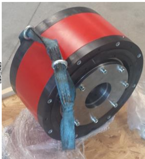
Figura 7 - Gruppo generatore elettrico (PTO)
