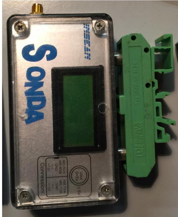
Figura 15 – Testa di misura della sonda capacitiva
