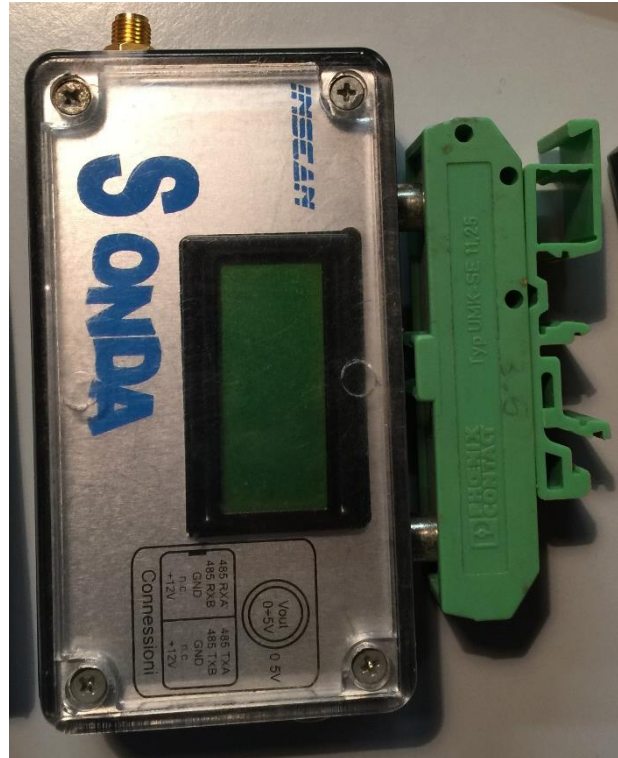
Figura 13 – Testa di misura della sonda capacitiva
