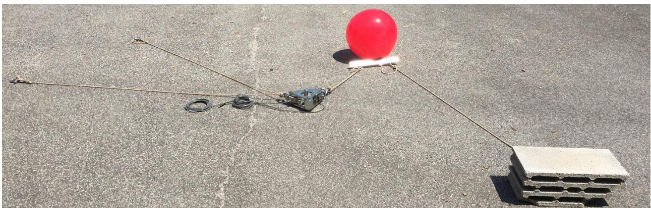
Figura 9 – configurazione dell'ormeggio a secco
