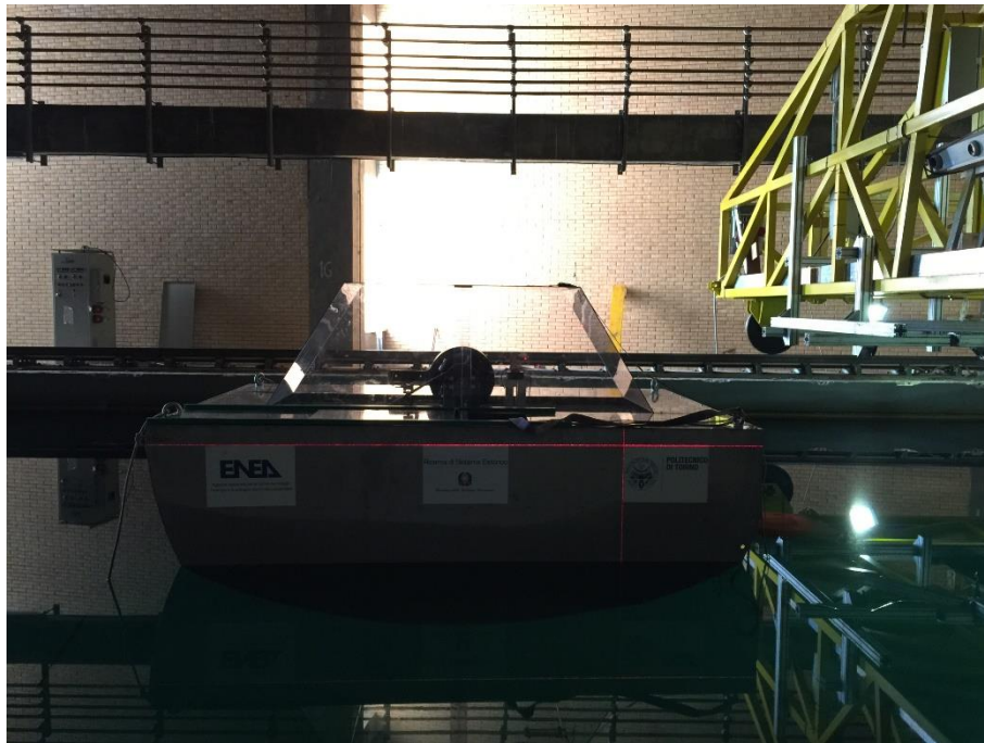
Figura 5 – Il prototipo in assetto di prova (vista laterale) con la copertura originale
