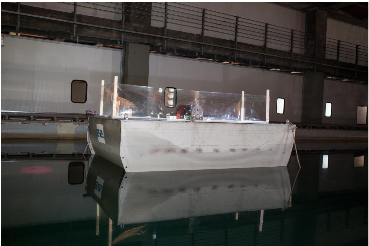
Figura 6 – Il prototipo in assetto di prova con copertura modificata per permettere oscillazioni del pendolo maggiori
