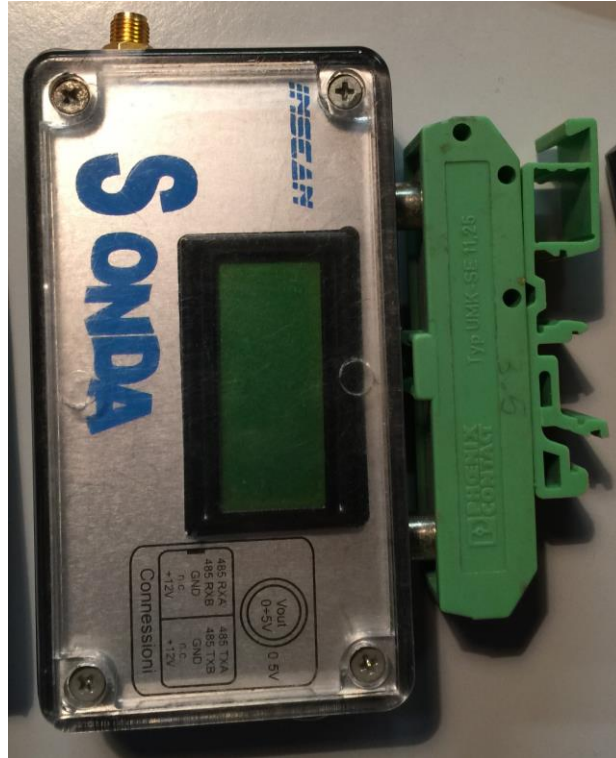
Figura 15 – Testa di misura della sonda capacitiva
