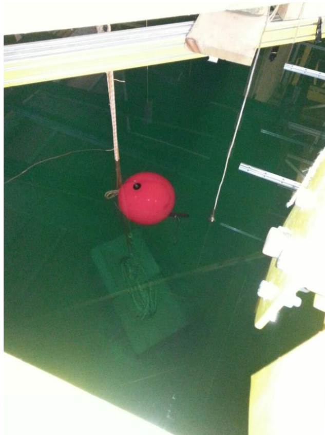
Figura 10 – Installazione del sistema di ormeggio (operazione di sollevamento e vincolo al corpo morto posto in fondo al bacino)
