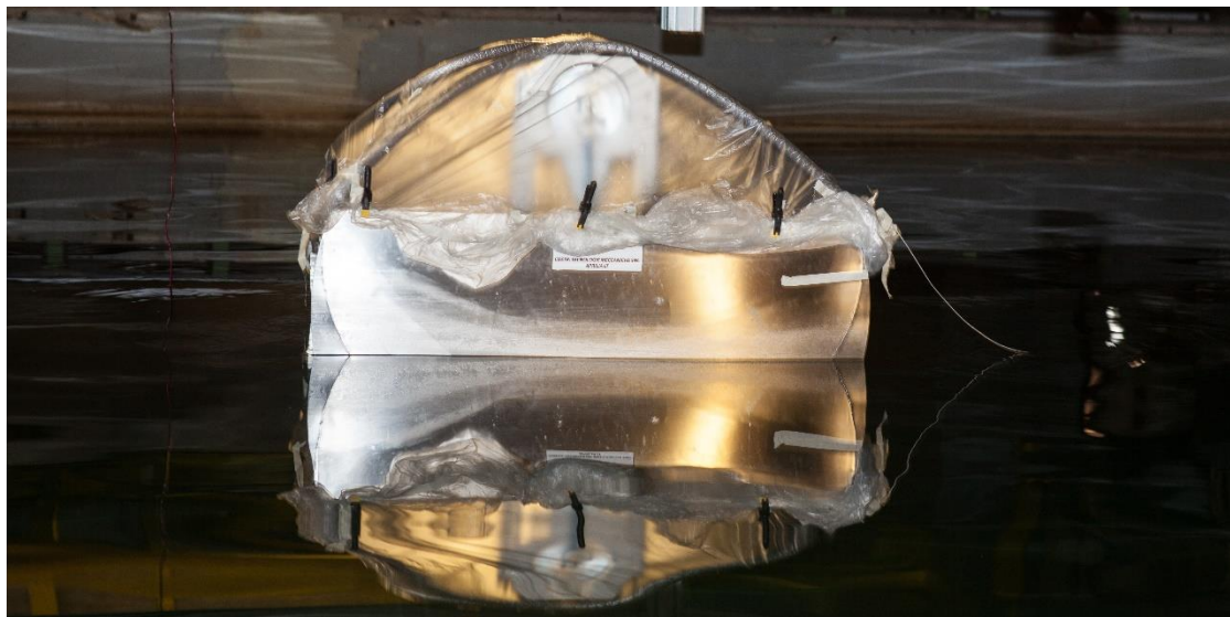
Figura 8 – Il prototipo in assetto di prova con copertura protettiva per le onde configurazioni ondose più critiche
