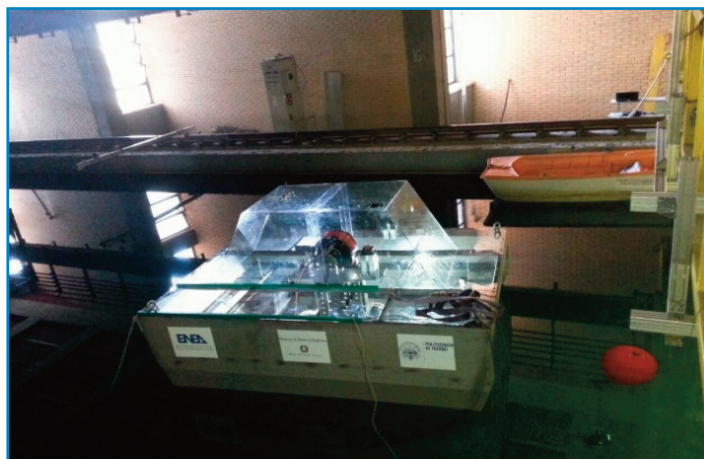
Foto del prototipo del PEWEC in assetto di prova
