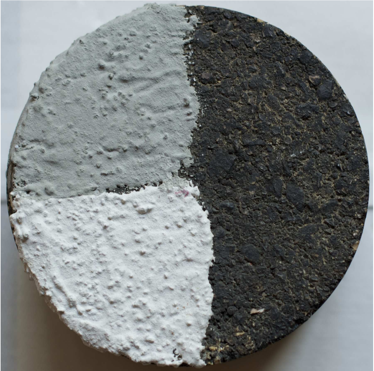
Figura 6 Carota numero 1 con asfalto originale (sample_1_road), asfalto con rivestimento in biossido di titanio grigio (sample_2_grey), asfalto con rivestimento in biossido di titanio bianco (sample_2_white).
