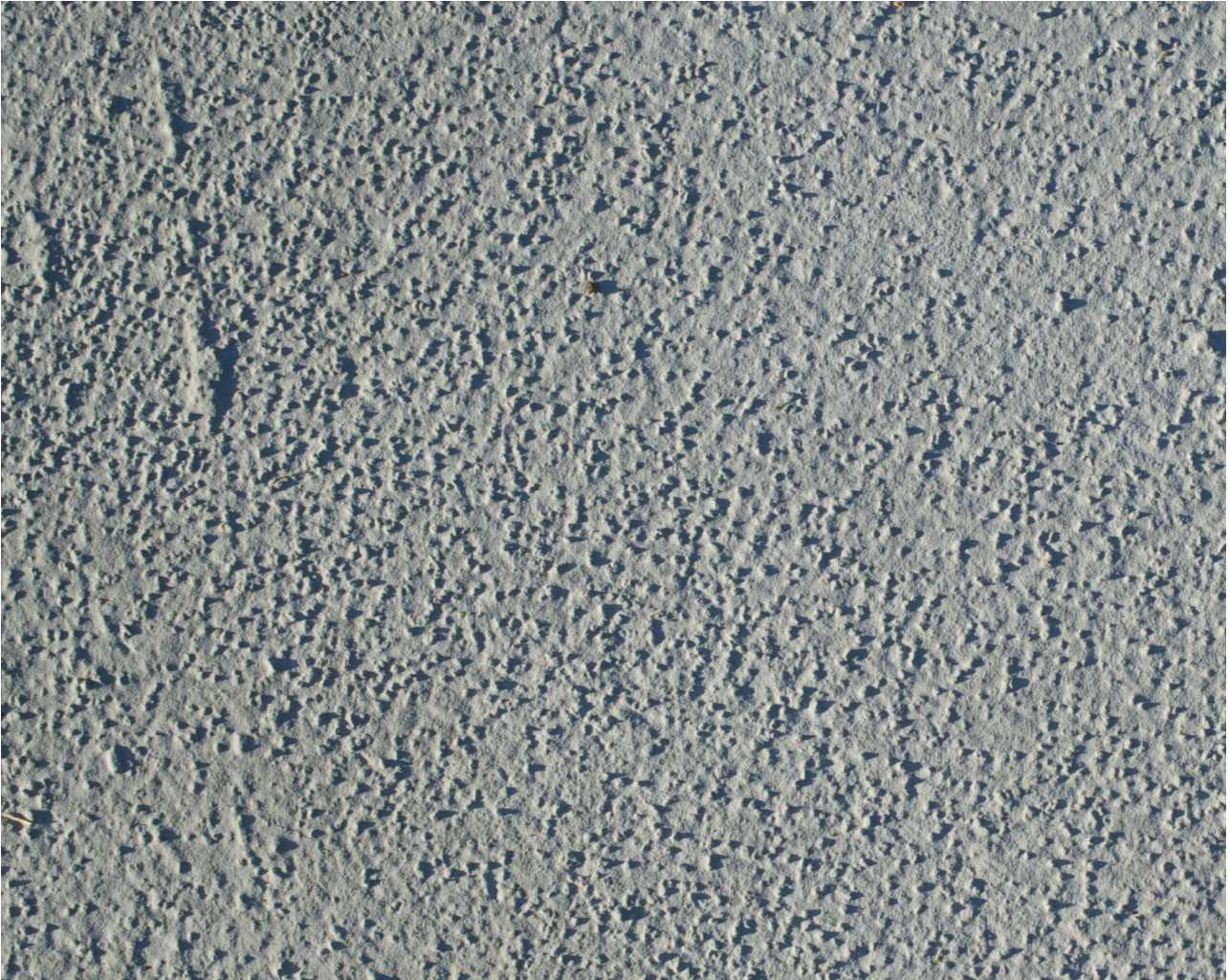
Figura 11 Sito sperimentale: particolare dell'asfalto trattato con rivestimento in biossido di titanio bianco.
