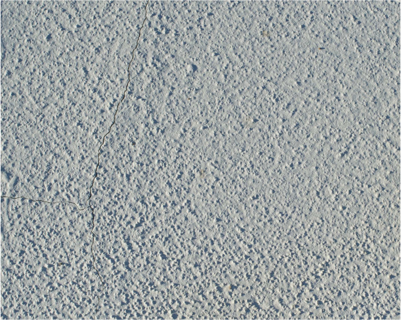
Figura 10 Sito sperimentale: particolare dell'asfalto trattato con rivestimento in biossido di titanio grigio.
