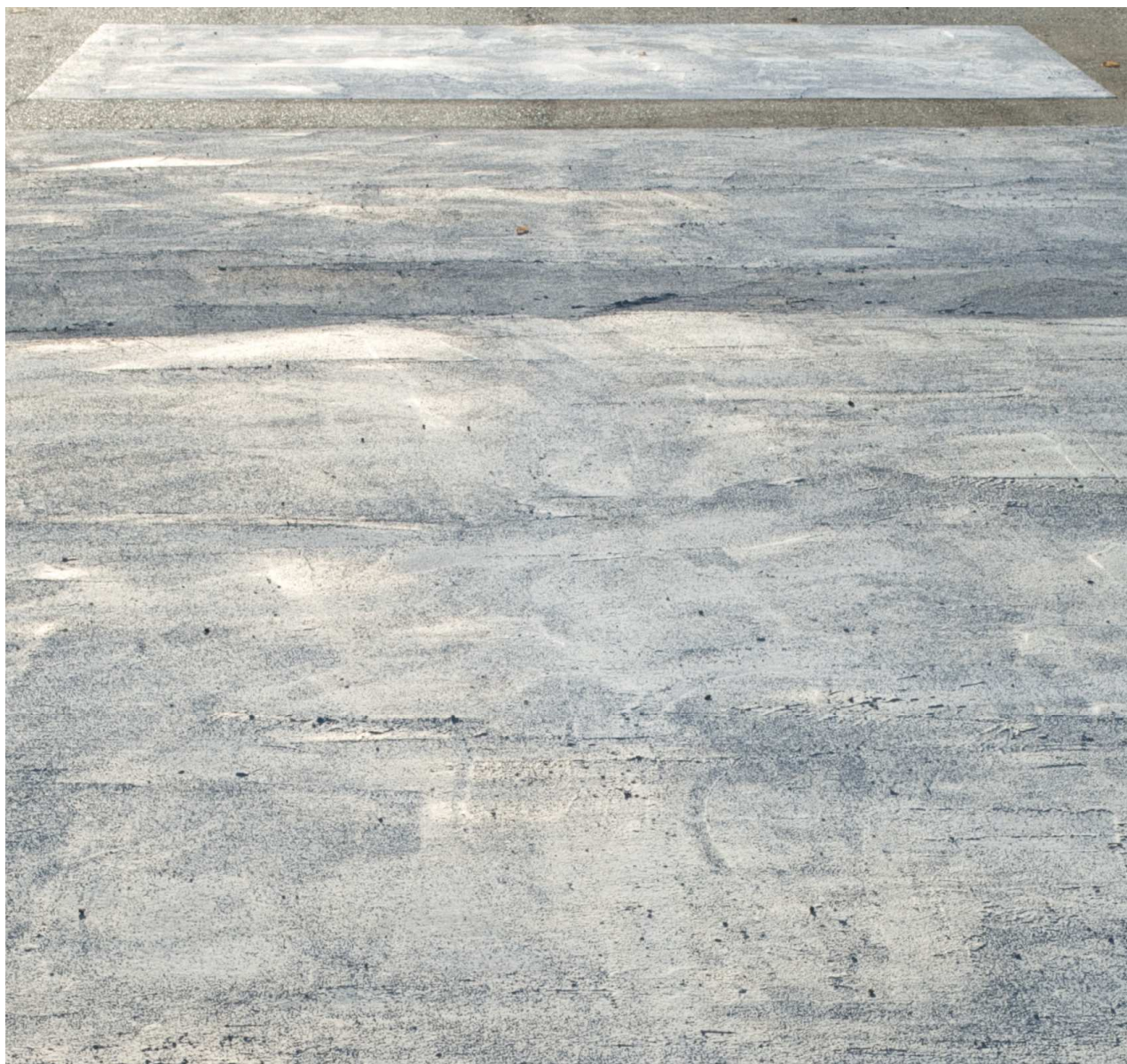
Figura 12 Sito sperimentale osservato con luce radente nella direzione della riflessione speculare con dall'alto, asfalto con rivestimento in biossido di titanio bianco, asfalto con rivestimento in biossido di titanio grigio.
