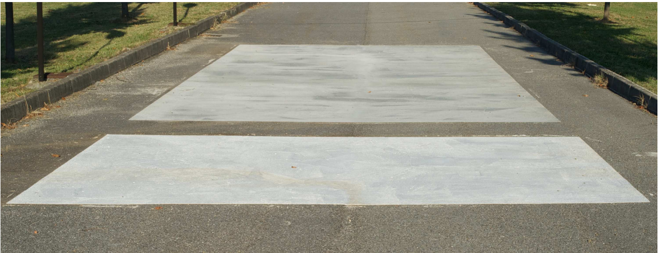
Figura 8 Sito sperimentale con dall'alto, asfalto originale, asfalto con rivestimento in biossido di titanio grigio, asfalto con rivestimento in biossido di titanio bianco.
