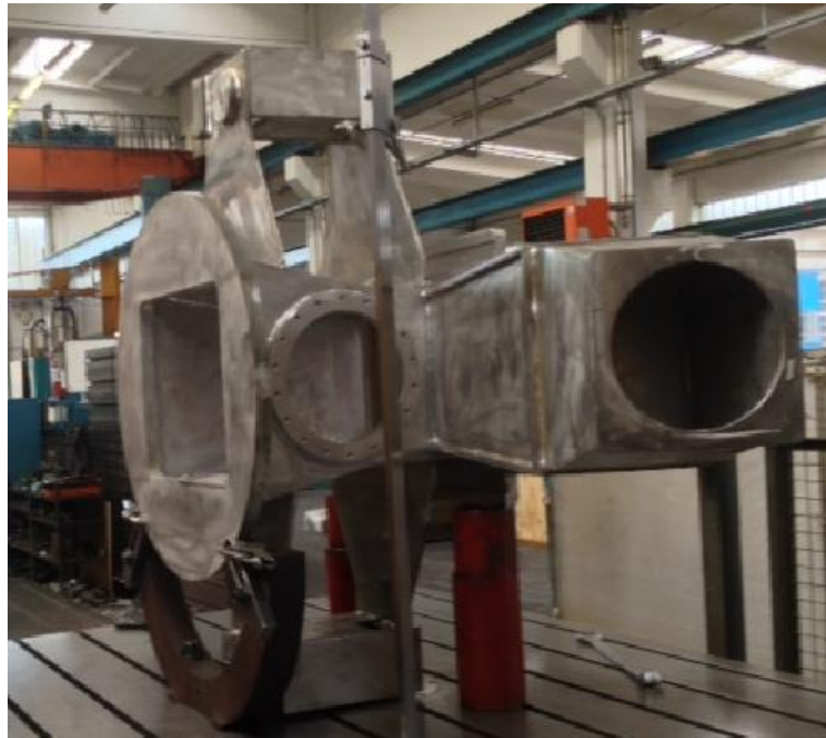
Fig. 15 TA body machining
