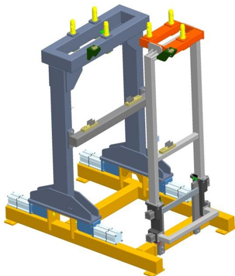
Fig. 8 Struttura di stoccaggio sistemi di presa
