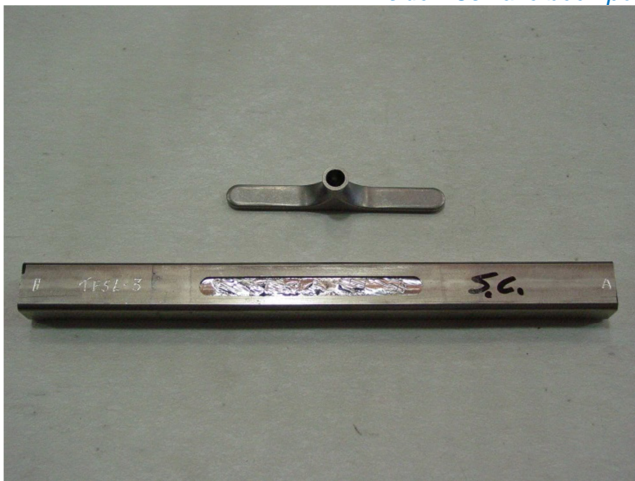
Fig.6 - Test preliminare per controllo delle temperature: inserto He inlet saldato su campione di conduttore 22x26 mm All'interno sono state posizionate le termocoppie sec. lo schema di Fig.2 Preliminary test for temperature control: He inlet welded on a 22x26 mm conductor sample Inside TCs have been positioned according to Fig.2 scheme
