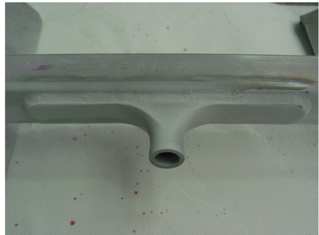
Fig.8 - Campione di qualifica / Welding qualification sample
