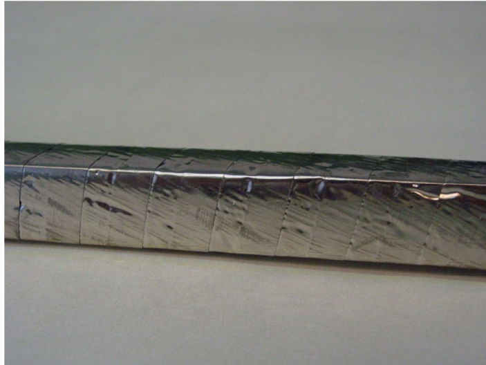
Fig.5 - Rimozione del jacket per analisi visiva dello stato del conduttore Removal of the jacket to perform a visual check of the conductor
