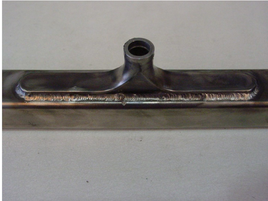
Fig.8 - Campione di qualifica / Welding qualification sample
