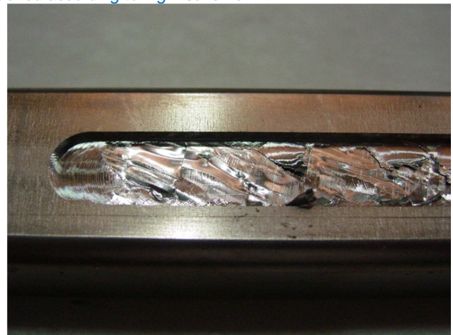
Fig.6 - Test preliminare per controllo delle temperature: inserto He inlet saldato su campione di conduttore 22x26 mm All'interno sono state posizionate le termocoppie sec. lo schema di Fig.2 Preliminary test for temperature control: He inlet welded on a 22x26 mm conductor sample Inside TCs have been positioned according to Fig.2 scheme
