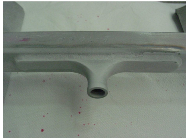
Fig.8 - Campione di qualifica / Welding qualification sample
