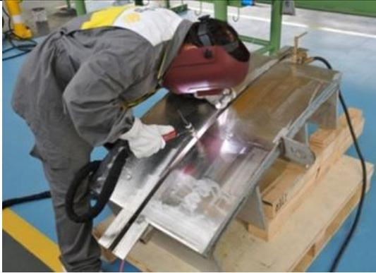
Figura 7. Operazione di saldatura in WT
