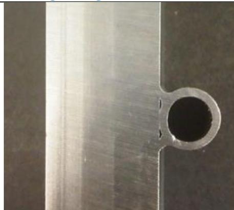
Figura 12. Saldatura del tubo di raffreddamento
