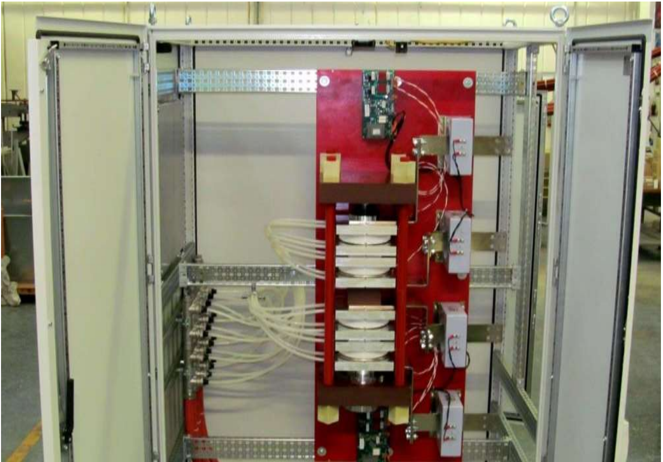
Figura 15. Armadio MS, fotografato dal lato portelle (il lato che si collega all'armadio R2 è a destra). Sono visibili i quattro tiristori in parallelo.
