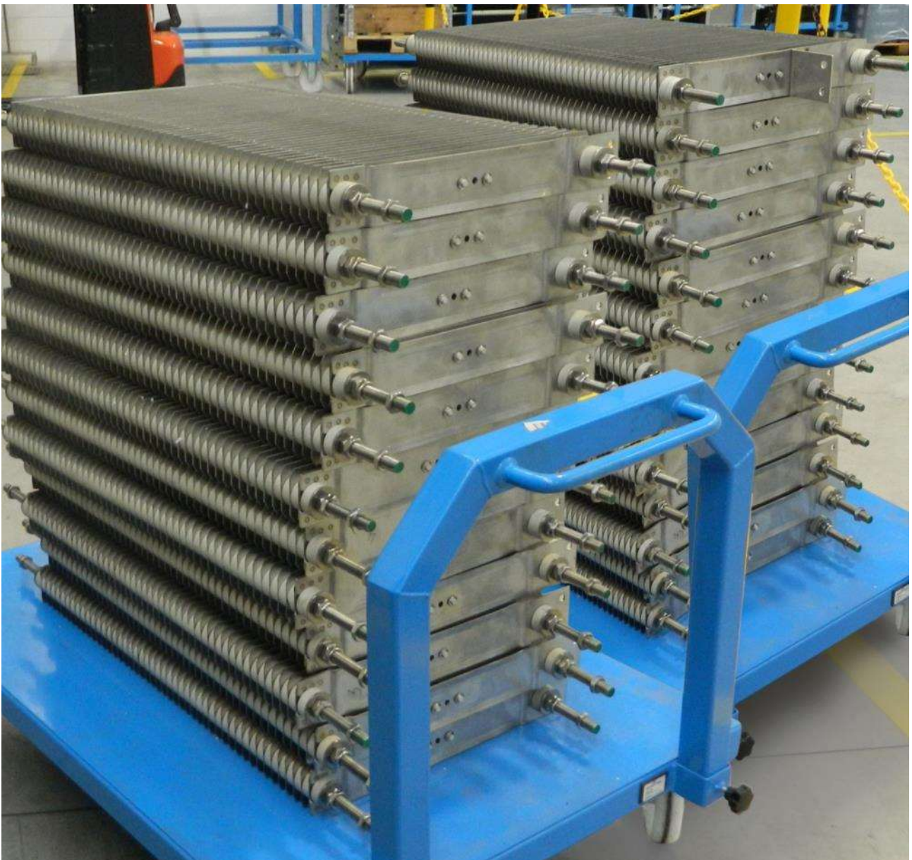
Figura 18. Pacchi resistivi del banco R1 nella configurazione finale prima dei collegamenti esterni.
