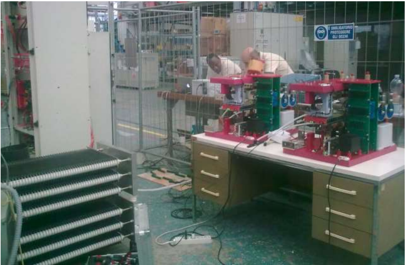
Figura 26. Due moduli dell'interruttore SCB in parallelo durante la prova con due rami nella sede della OCEM Energy Technology. Nell'angolo in basso a sinistra è possibile intravedere un banco di resistori R1 usato durante la prova.
