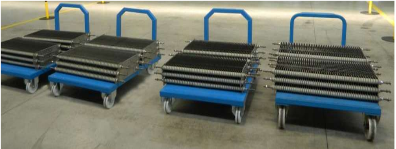
Figura 17. Pacchi resistivi del banco R1 prima dell'assemblaggio.
