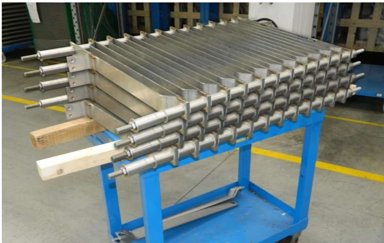
Figura 20. Pacchi resistivi di R2 nella configurazione finale.
