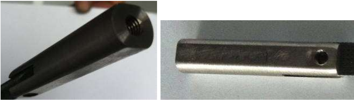
Figura 8 – particolare 5 in acciaio AISI 316 e lavorazione meccanica con elettroerosione a filo
