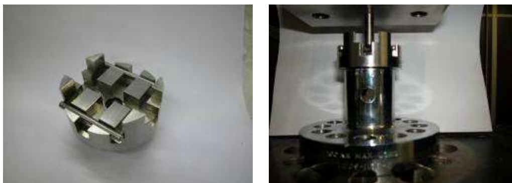
Figura 12 – Particolari dell’attrezzatura per le prove di trazione
