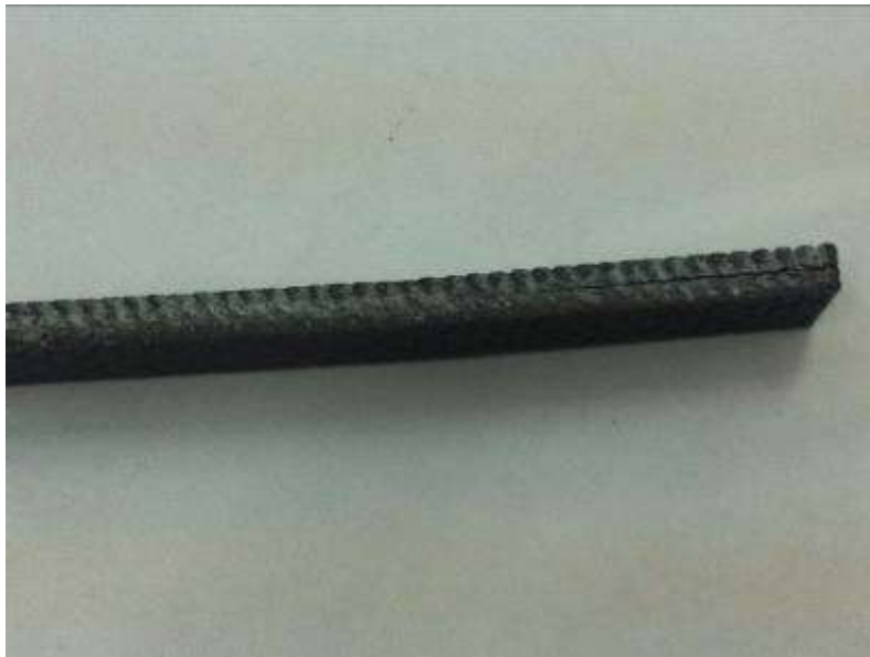
Figura 14– particolare campione FUS2/2 dopo prova di flessione a 3 punti
