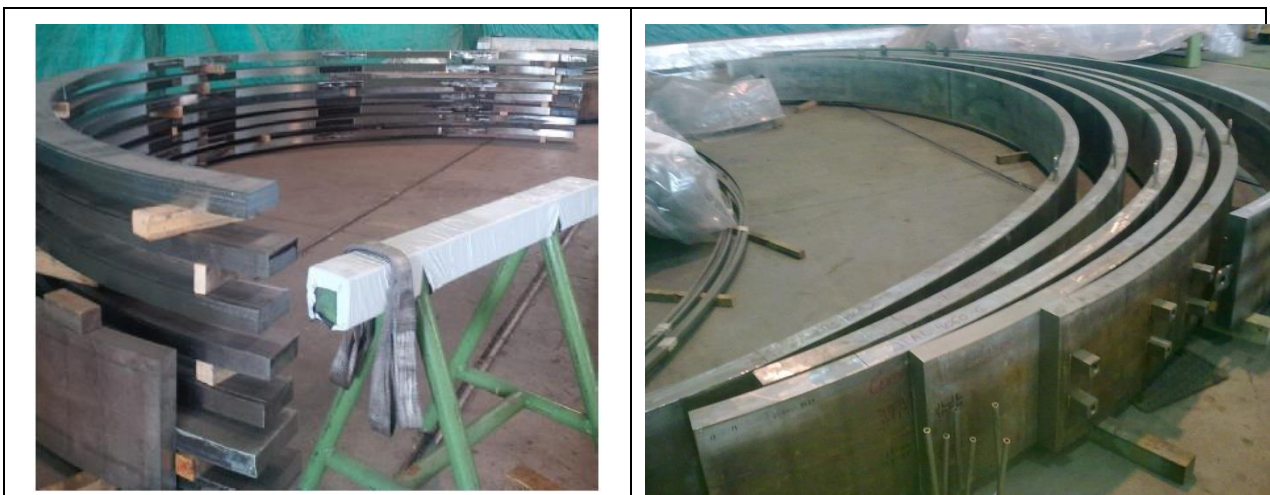
Figura 12: Ali e basi delle gambe curve
