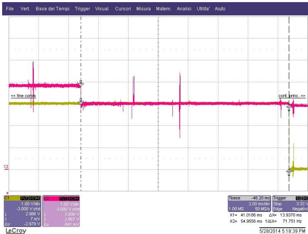
Figura 16. Schermata dell'oscilloscopio per la misura del tempo di apertura meccanica del BPS. In questo caso, il tempo di apertura stimato è intorno al valore medio tra le ripetizioni (circa 14 ms).
