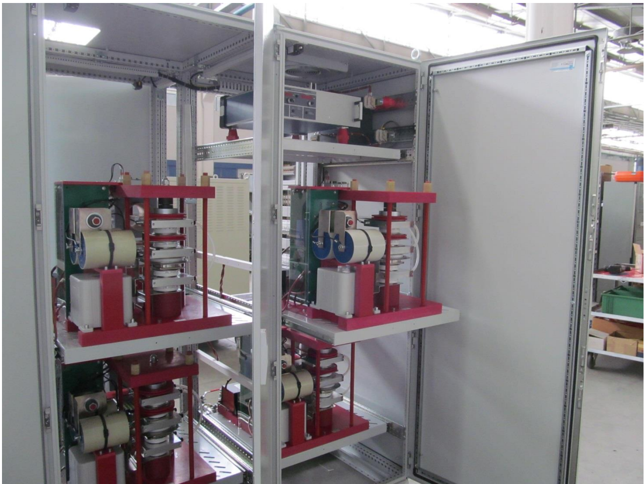
Figura 8. Dettaglio degli stack di un ramo dell’SCB. Per facilitare le attività di installazione e manutenzione ogni stack è montato su un supporto estraibile.
