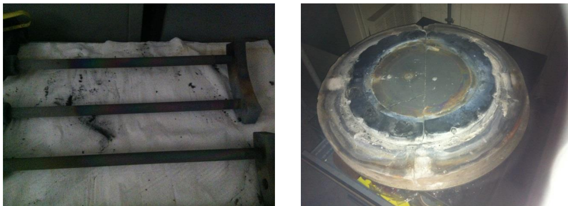
Figura 28. Resistori di grafite e allumina esausti.
