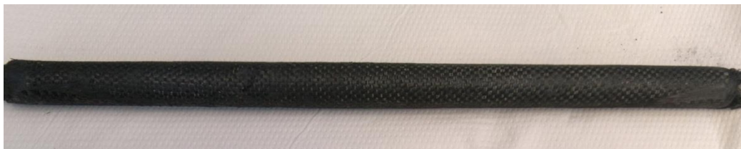
Figura 9. Preforma di tubo in SiC/SiC
