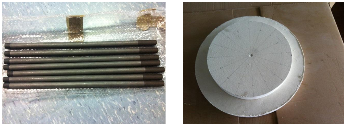
Figura 29. Resistori di grafite e allumina nuovi.
