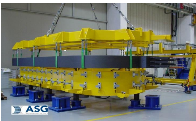
Figura 24 Inserimento del primo avvolgimento nell'attrezzatura di inserimento
