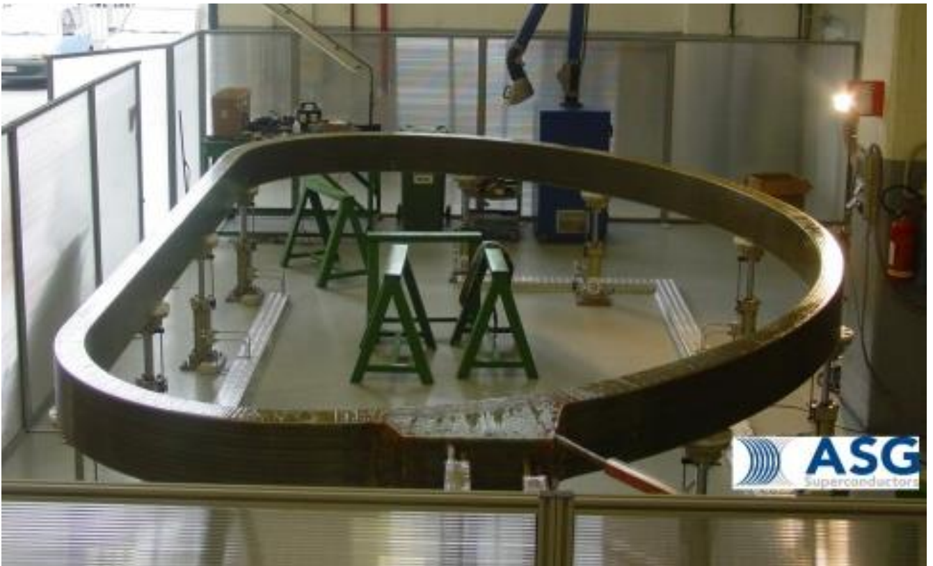
Figura 5 Operazione di pulizia e verniciatura del WP04
