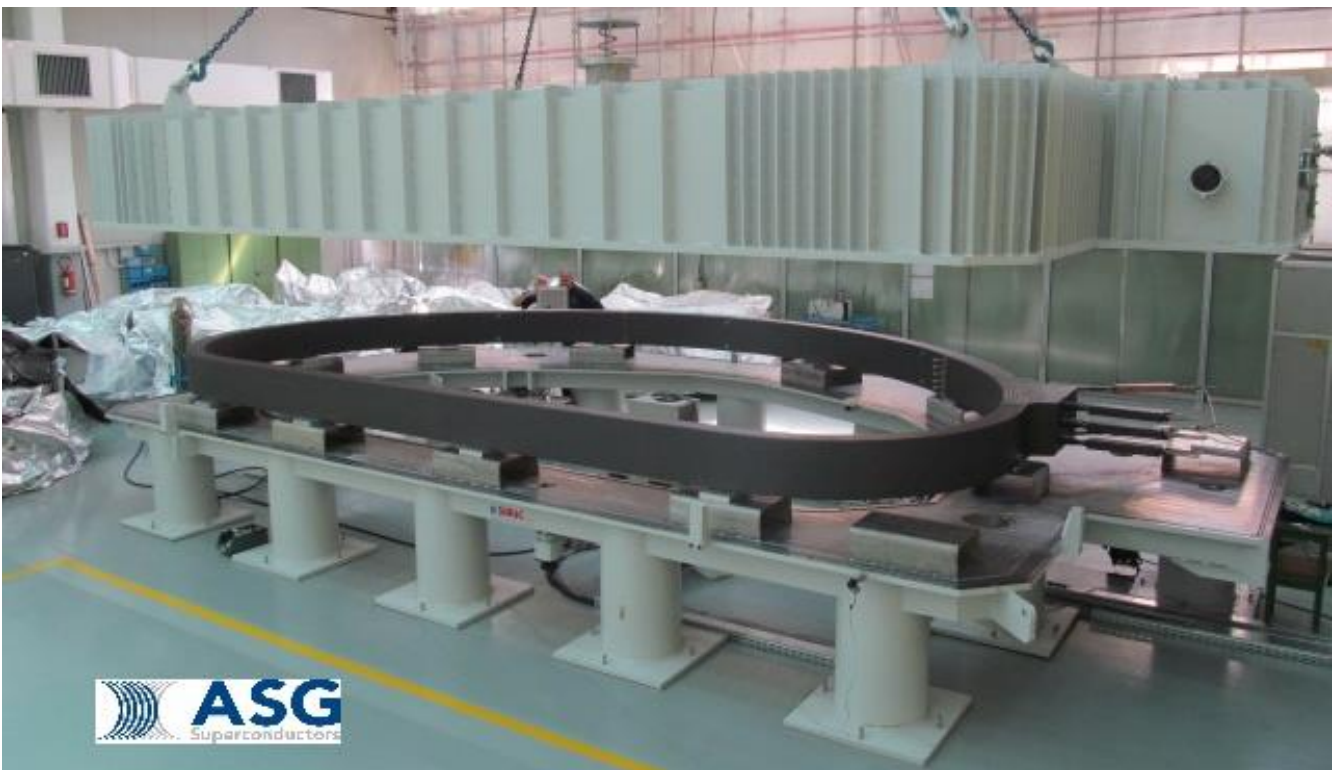
Figura 6 Un WP viene inserito in camera da vuoto per l'esecuzione del test di tenuta
