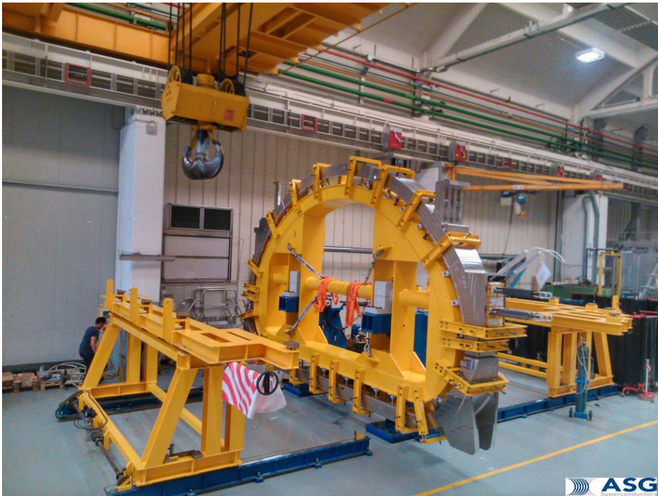
Figura 26 Avvio delle operazioni di saldatura trasversale
