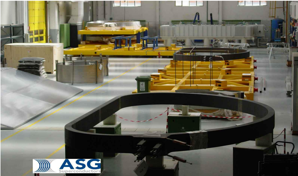
Figura 8 Un WP pronto per l'esecuzione dei controlli dimensionali finali
