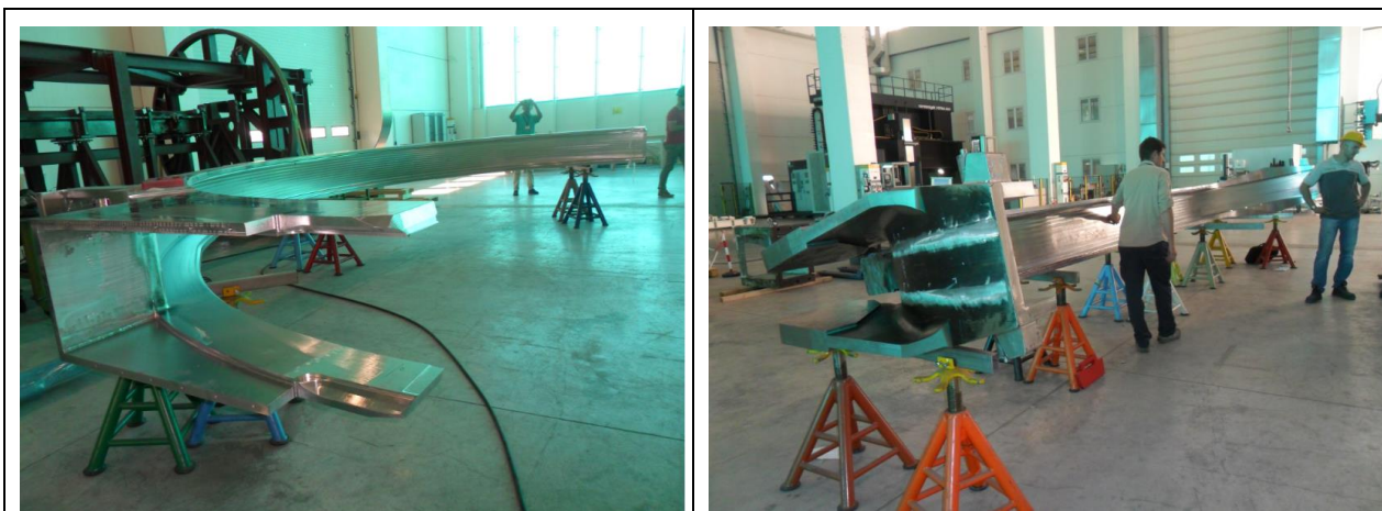
Figura 19 Gamba curva del 5 casing (ASG-C, in fase di rifinitura) e gamba dritta del 6 casing (ALSTOM-C, in fase di misura).
