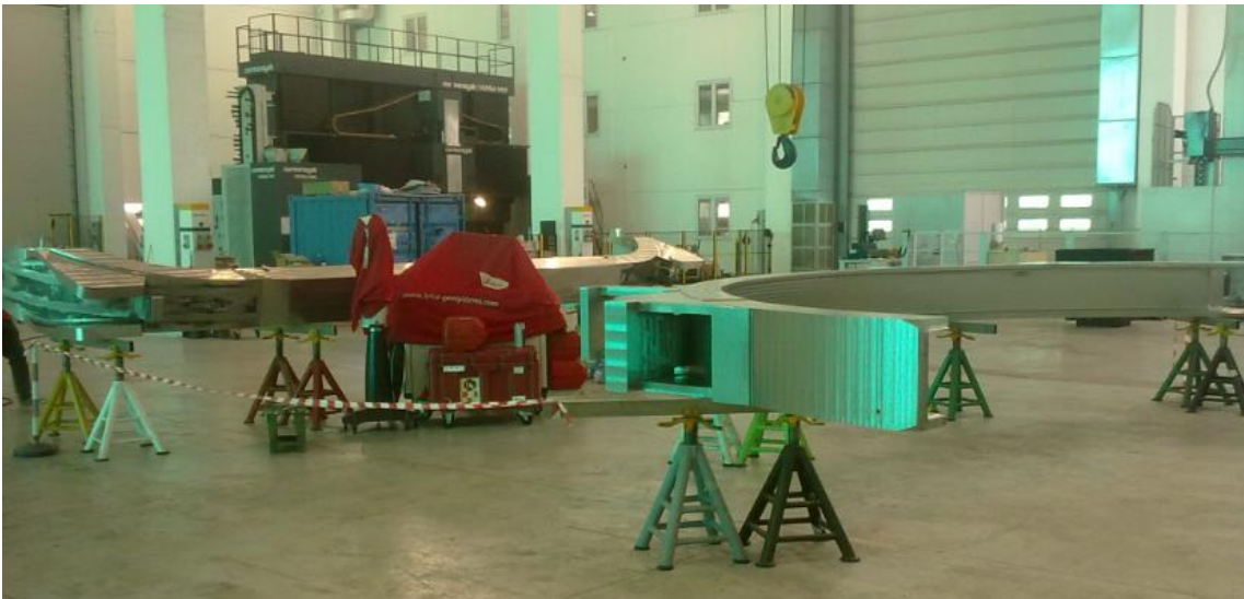
Figura 17: Gamba dritta e gamba curva del 3° casing consegnato, il secondo per ASG (ASG-B).
