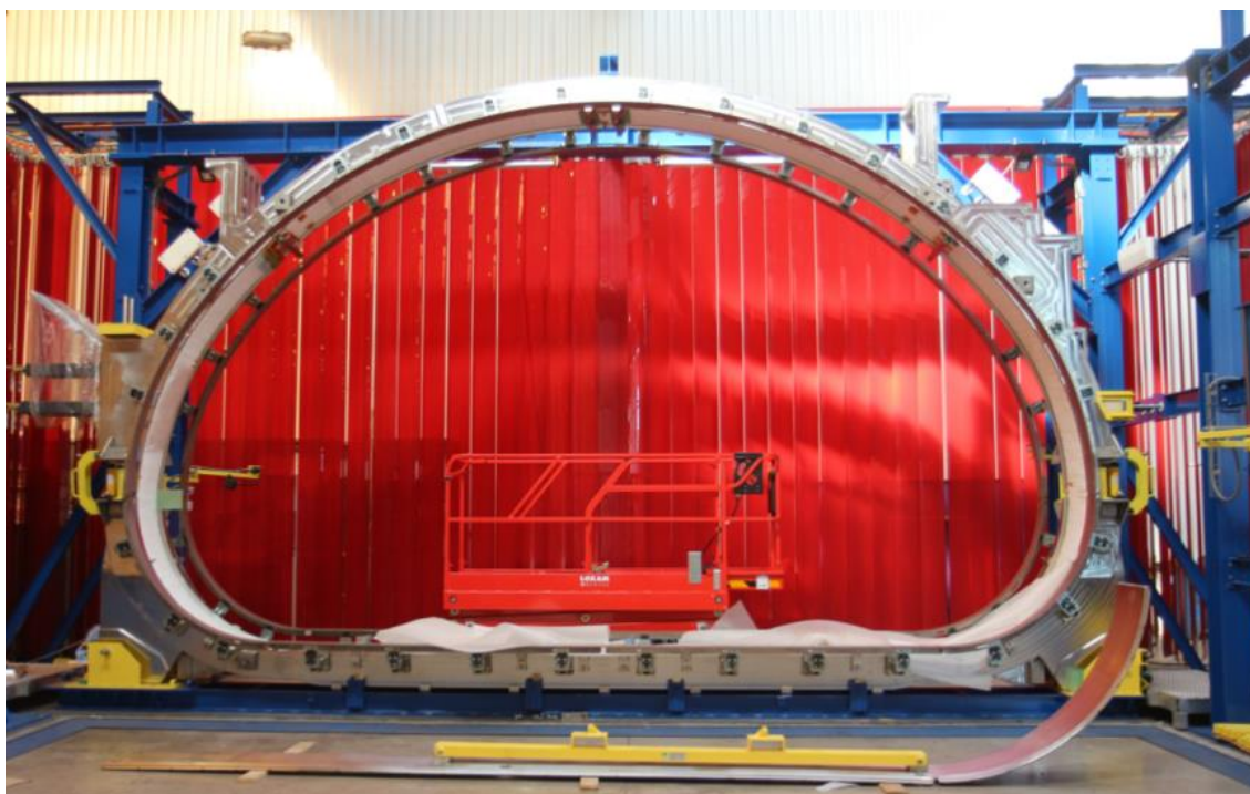
Figura 9: Inserimento bobina nel primo casing (ALSTOM-A) in ALSTOM, maggio 2015 (Courtesy of ALSTOM).
