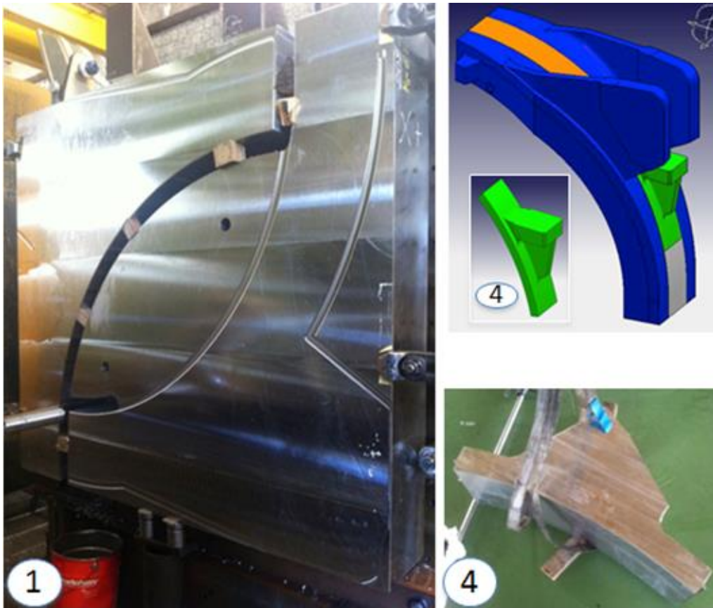
Figura 3: Taglio, composizione, saldatura e lavorazione dei gomiti della gamba dritta.
