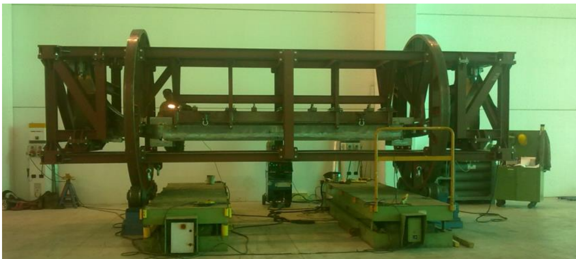
Figura 2: Attrezzatura di montaggio della gamba dritta in fase di saldatura traversa dei gomiti sulla parte dritta.
