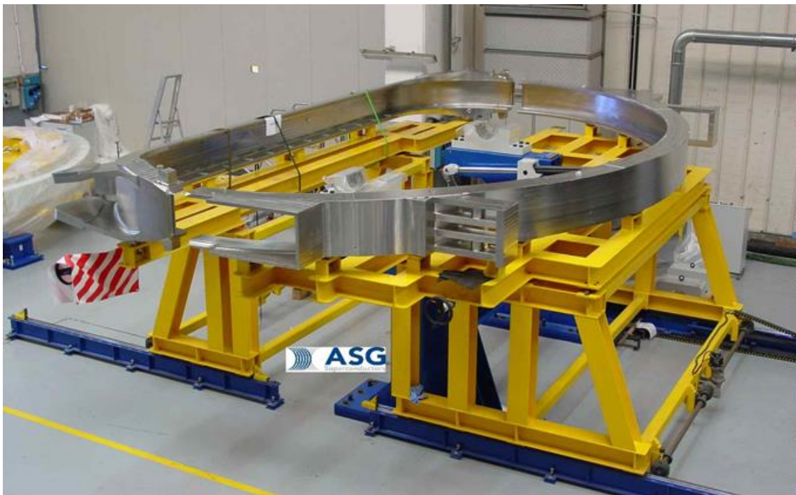
Figura 15: Gamba dritta e gamba curva del 2° casing in fase di assemblaggio in ASG (ASG-A)( Courtesy of ASG).
