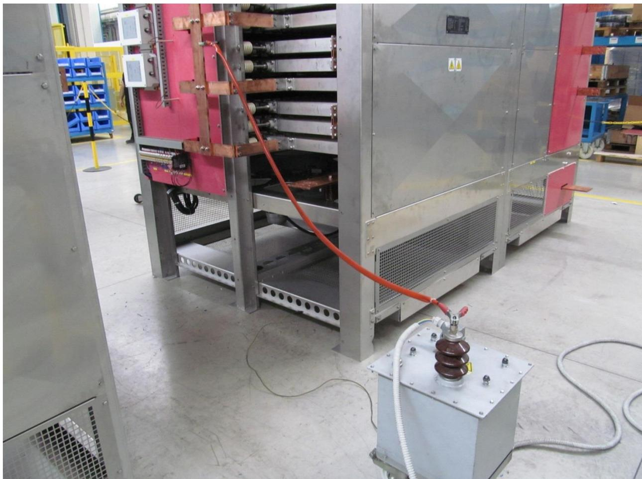
Figura 10. Cubicle di R2 durante il test di isolamento.
