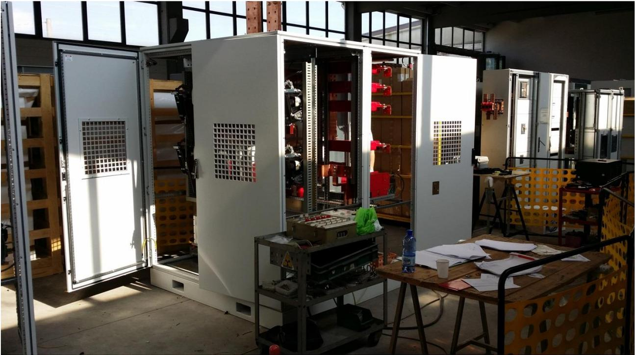
Figura 13. Cubicle dei BPS delle tre SNU di serie durante le prove di tenuta in tensione.
