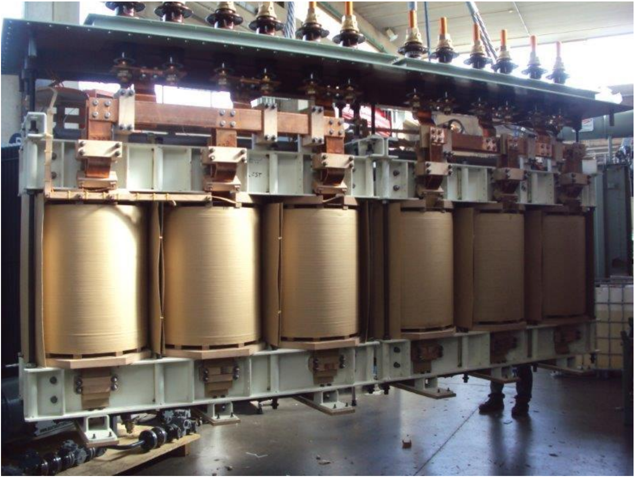
Figura 3 - Costruzione del trasformatore CS3.
