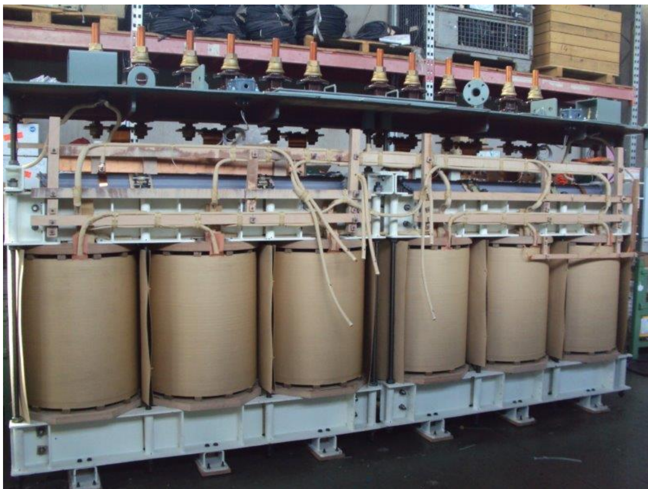
Figura 2 - Costruzione del trasformatore CS2.
