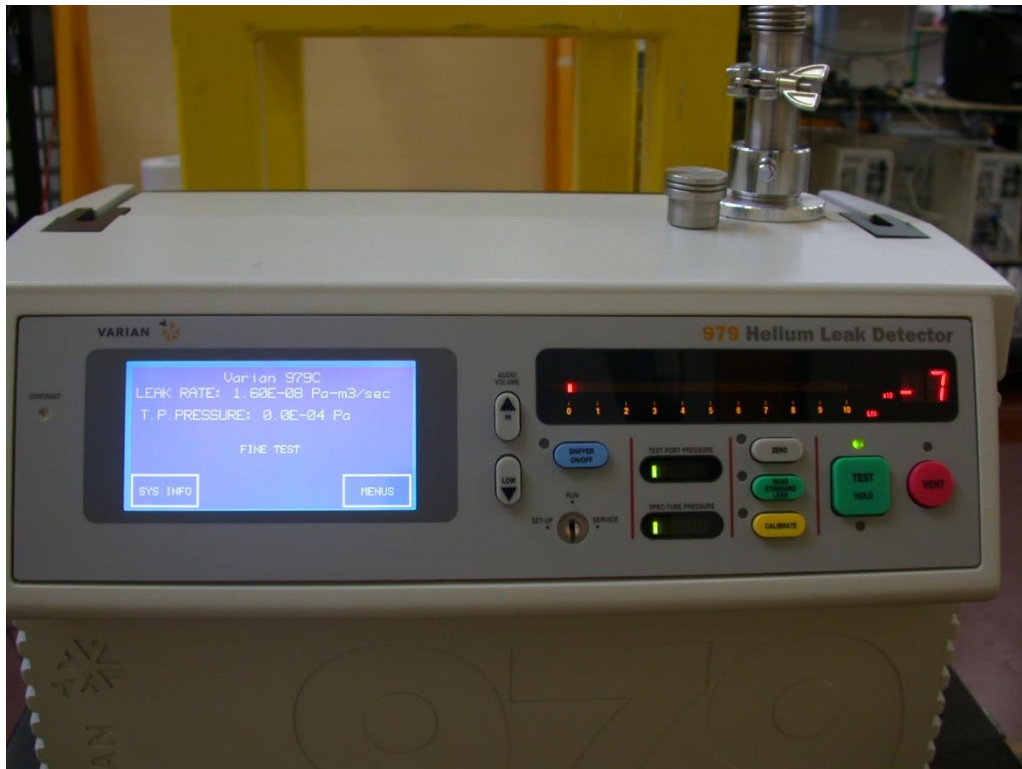
Figura 16 Cerca fughe utilizzato per la prova di vuoto e la misura delle perdite del TA
