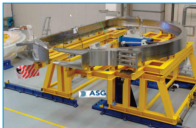
Gamba dritta e gamba curva del 2° casing in fase di assemblaggio in ASG Superconductors SpA di Genova
