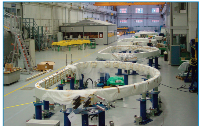
Vista degli avvolgimenti in attesa dell'inserimento nelle casse di contenimento
