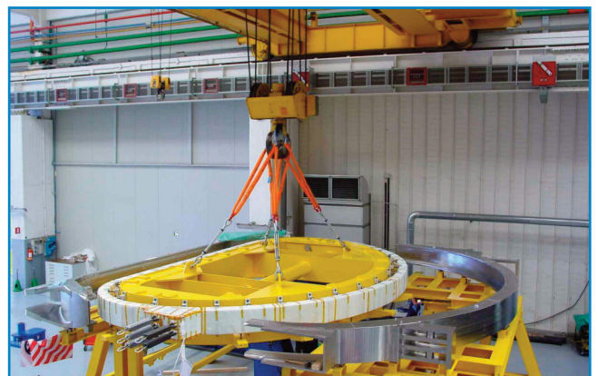
Inserimento del primo avvolgimento nella cassa di contenimento
