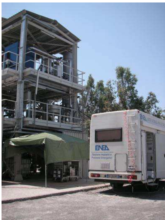
Fig. 16: Laboratorio mobile di analisi gas ENEA e carrello di prelievo e analisi gascromatografica
