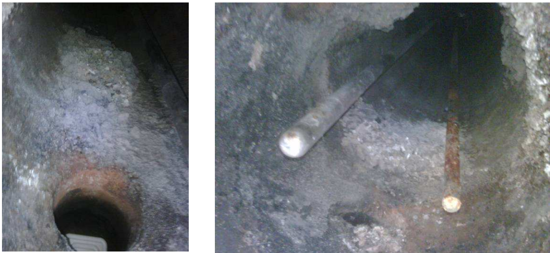
Fig. 27: Visione dal basso dell'interno del gassificatore con dettaglio delle sonde di misura di livello e temperatura
