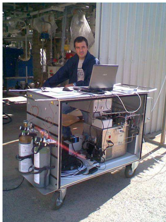
Fig. 16: Laboratorio mobile di analisi gas ENEA e carrello di prelievo e analisi gascromatografica
