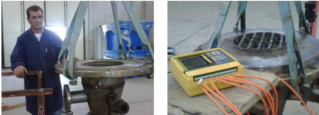
Fig. 19: Operazioni di modifica della griglia e Datalogger termocoppie.
