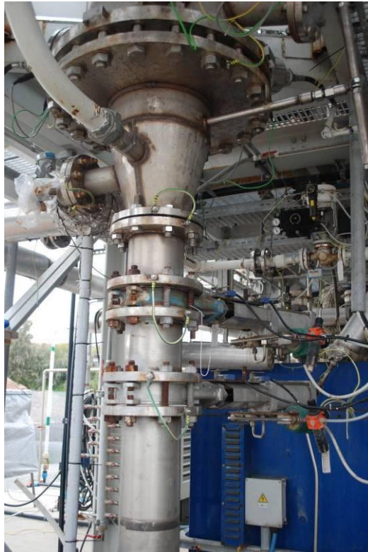
Figura 2.2. Condotto di adduzione degli agenti gassificanti e ghigliottine per lo scarico delle ceneri.
