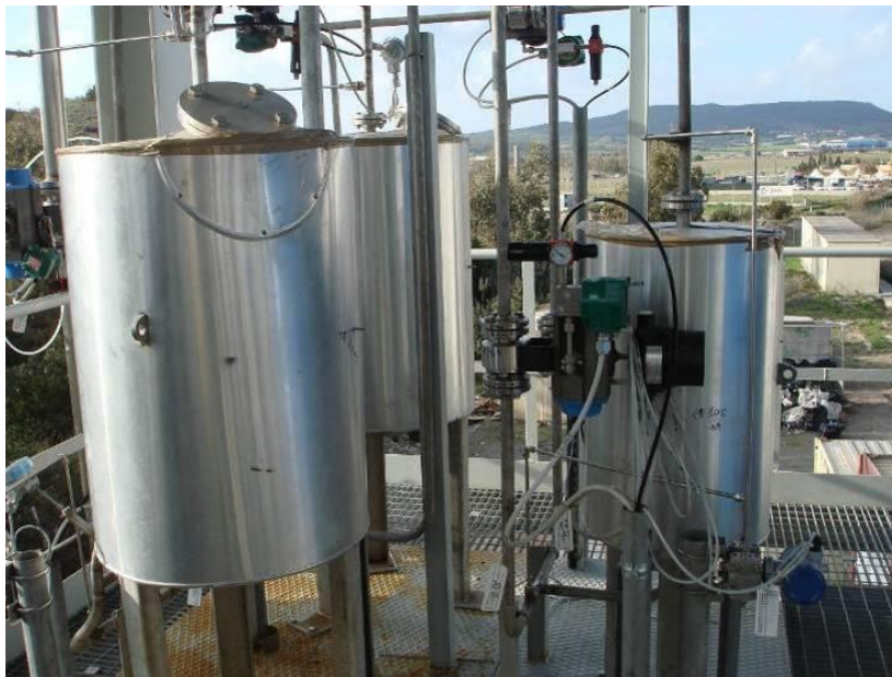
Figura 2.5. Sistema di desolfurazione a caldo del syngas.
