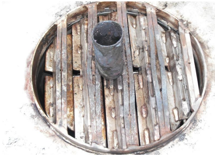
Figura 6.1 Condizioni della griglia dopo le prove sperimentali
