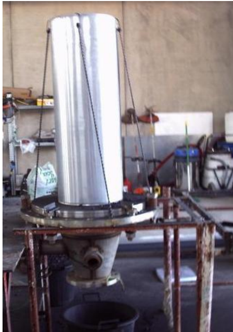
Figura 3.8 Sistema sperimentale per simulazione scarico ceneri
