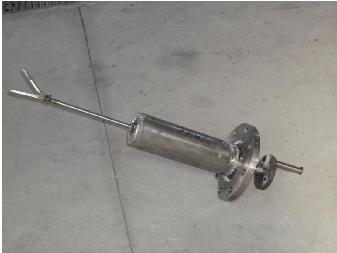
Foto10. sistema di movimentazione del letto del gassificatore
