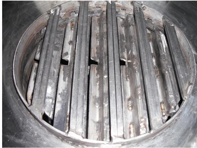
Figura 3.6 griglia modificata in posizione di chiusura
