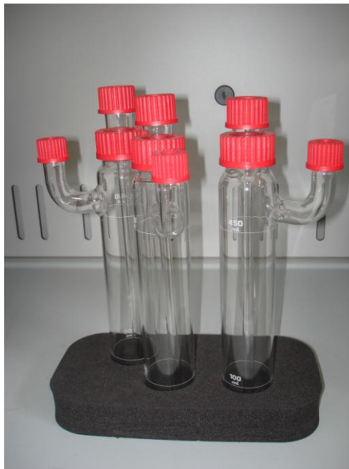
Fig. 5 - Sistema di tre gorgogliatori per la separazione dell'umidità e del TAR dal gas di sintesi
