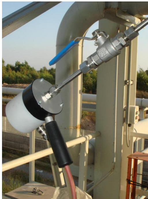
Fig. 4 – Sonda con filtro riscaldato per il campionamento del syngas
