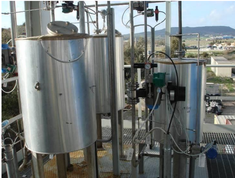
Figura 2.5. Sistema di desolforazione a caldo del syngas.
