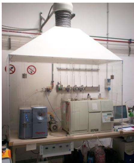
Figura 6. Apparato da laboratorio per le misure di adsorbimento di H<sub>2</sub>S
