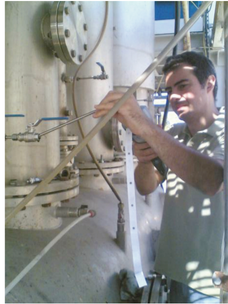
Misure di sporcamiento con gli opacimetri
