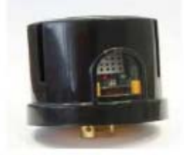
Figura 73 Sistema di controllo/diagnostica in sostituzione dell'interruttore fotoelettrico
