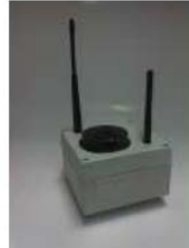
Figura 80 TYCO. Sistema di controllo e monitoraggio della lampada Ceckpoint in sostituzione dell'interruttore fotoelettrico standard (a sinistra) e l'Access point da incorporare all'interno dell'apparecchio in sostituzione del normale interruttore fotoelettrico e svolge le medesime funzioni del CeckPoint, oltre che il controllo della rete
