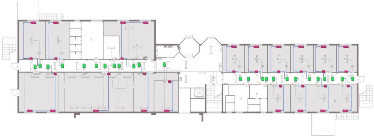
Disposizione dei fan coil, dei termostati e dei trasmettitori di segnale Elios
