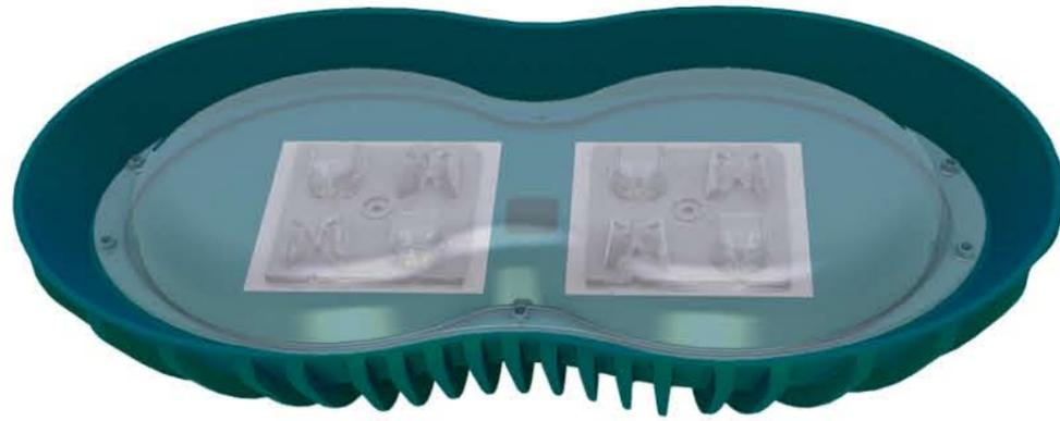
L'immagine mostra l'assemblaggio della coppa superiore in PMMA rispetto alla parte ottica (LED+PCB+LENTI) e dissipativa, realizzata in alluminio. In particolare si noti l'indentatura che segue la sagoma della coppa e che permette di alloggiare la stessa in maniera corretta e di assemblare le due parti interponendo un gel adesivo di fissaggio e chiusura ermetica delle due parti.
