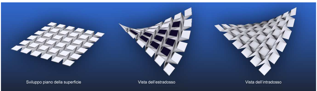
Figura 29 - Esempio di sviluppo della superficie nello spazio. Gli elementi restano privi di doppia curvatura anche quando la superficie assume geometrie complesse
