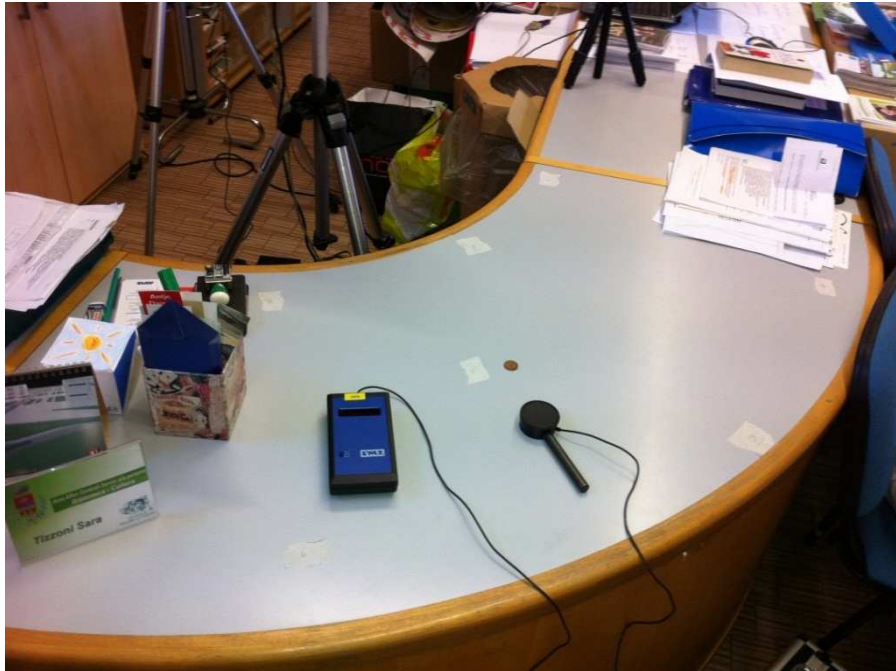
Figura 45 Misura degli illuminamenti sulla scrivania del bibliotecario
