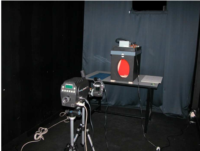
Figura 26 Setup di misura utilizzato per la calibrazione dello strumento
