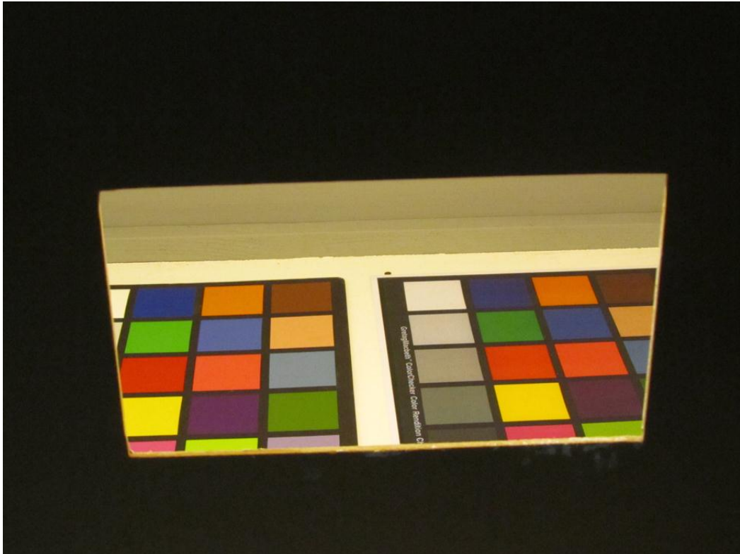
Figure 6: setup del secondo esperimento. A destra il Color Checker originale, a sinistra la sua riproduzione
