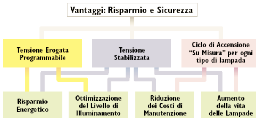
Fig. 2.3: vantaggi della regolazione del flusso luminoso
